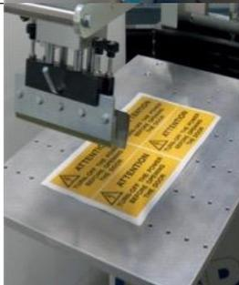
**CH** Dispositif avec aspiration (pompe incluse)
